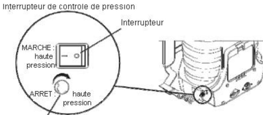
• Rappelez-vous que le pulvérisateur est en « Haute pression » en utilisant l'interrupteur électrique.
