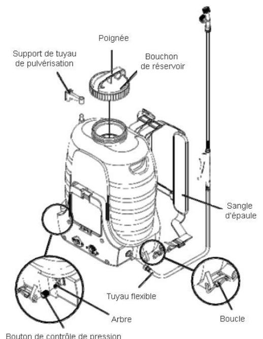
**Attention** Assembler et serrer le tuyau flexible sur le corps principal pour que le liquide ne fuit pas.
